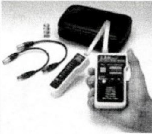
Es un equipo con el cual se puede fácilmente chequear la configuración correcta de un cable 10-base-t (cat 5), 10-base-2 (coax) , rj45-rj11 (modulares), 356a , 358a y b , y token-ring. El equipo consta de 2 partes, el generador remoto, y el terminador. El generador remoto puede probar cables instalados en larga distancia (hasta 350 metros). Puede verificar continuidad, rupturas, cortocircuitos y crossovers. Display de status multiled. indica que par especifico del cable presenta fallas.
