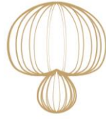
Figura 13. Patrón polar Super Cardioide.
