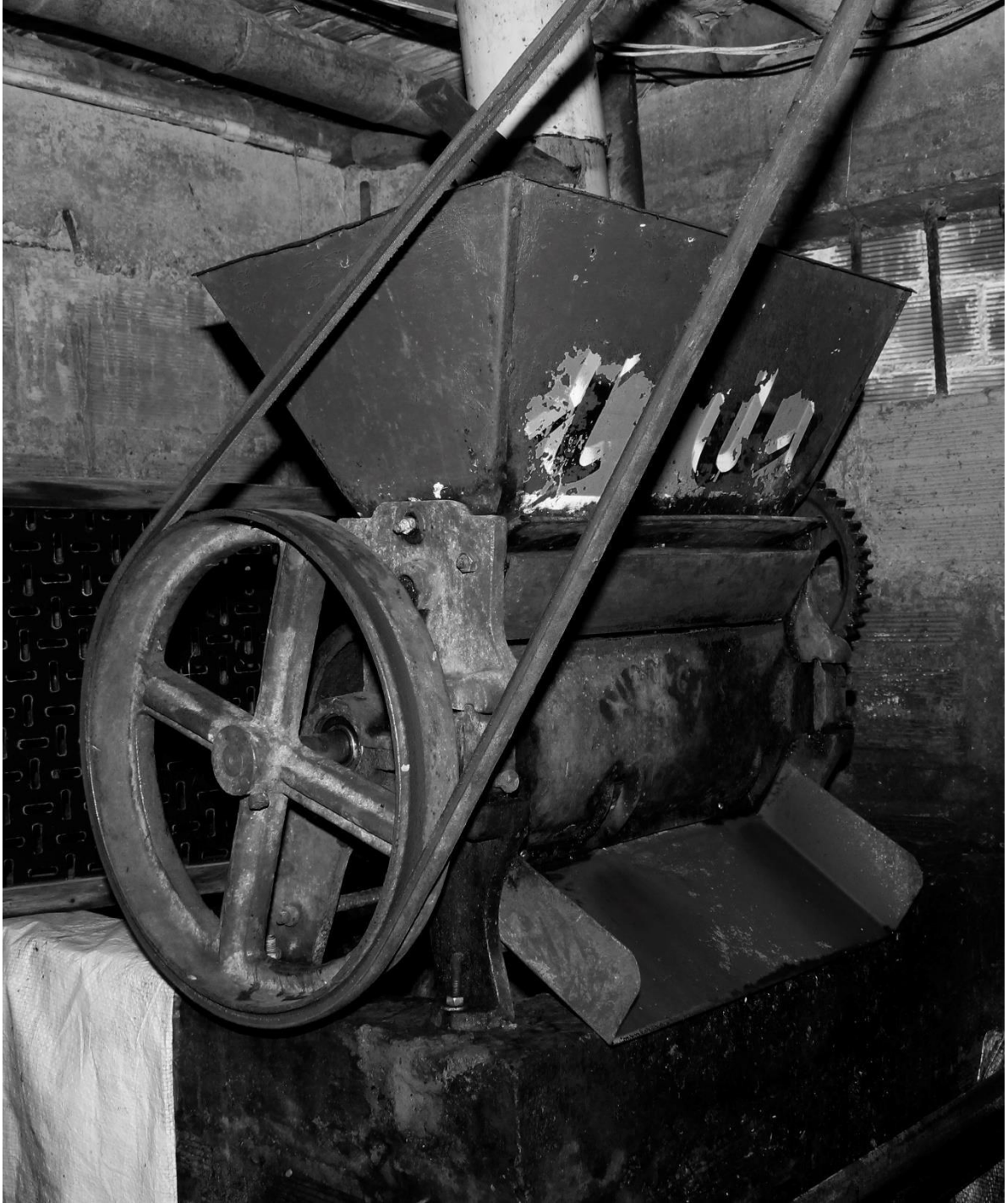
Figura 29. Trilladora de café. Su uso es indispensable para romper la cereza y extraer la almendra de café, esta máquina tiene más de 50 años de uso, podemos observar que la producción de café está caracterizada por la tradición de nuestros antepasados cafeteros. Foto tomada por Laura Daniela Bonilla Hernández
