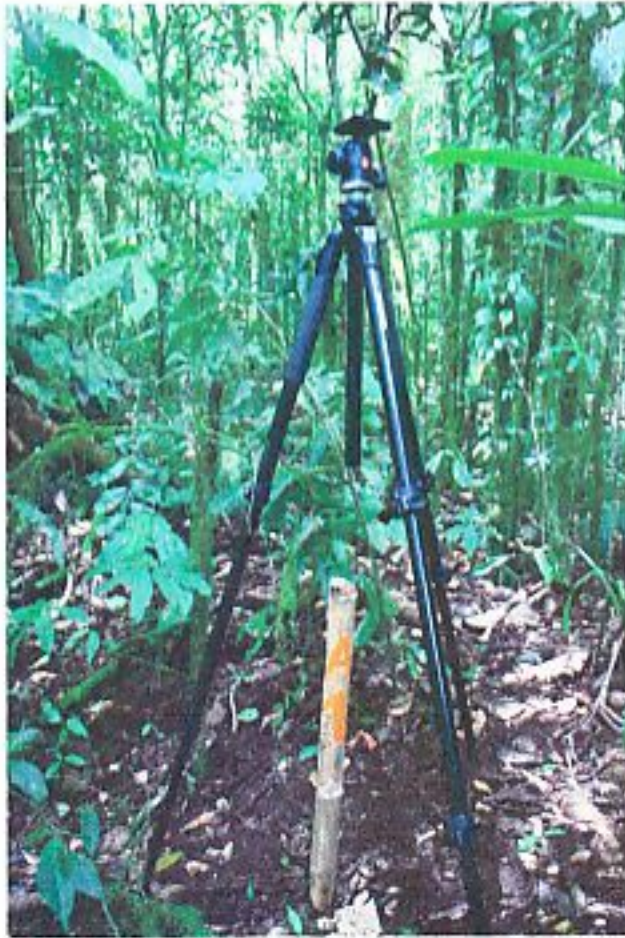
Posición del trípode dispuesto para las tomas, con relación a cada punto.
