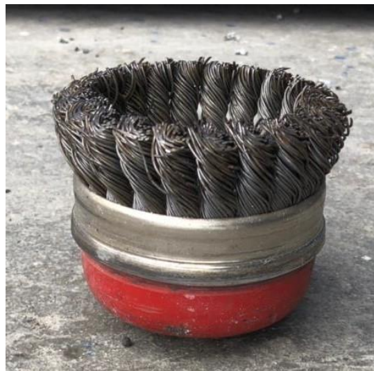
Figura 4. Grata copa utilizada en el proceso actual de limpieza de perfiles metálicos.
