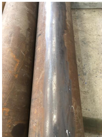
Figura 12. Acabado limpieza con disco Flap.
