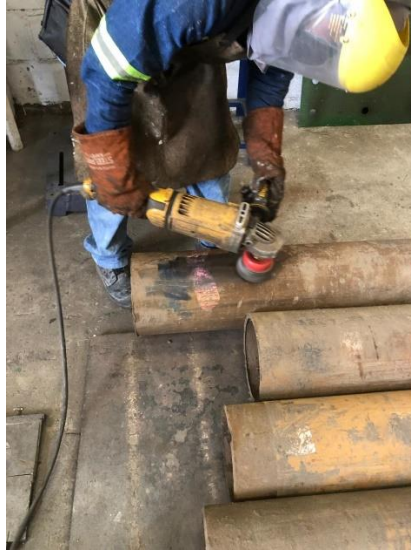
Figura 5. Operario realizando proceso actual de limpieza de perfiles metálicos.
